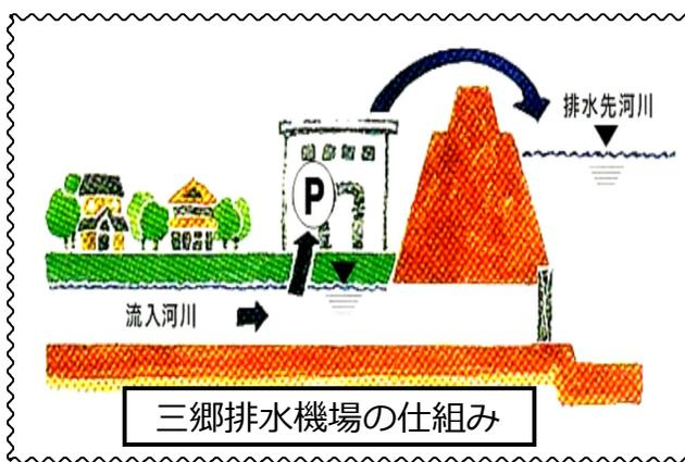
今回中川の水を江戸川に排水する三郷排水機場のポンプ（左図参照）が5台中3台が稼働せず、200トン排水能力中80トンしか稼働できず、中川の水位が上昇した可能性があります。これからの治水対策は、流域全体で水を少しでも貯留し、下流部への負担を減少する努力を全国で行う必要があります。
